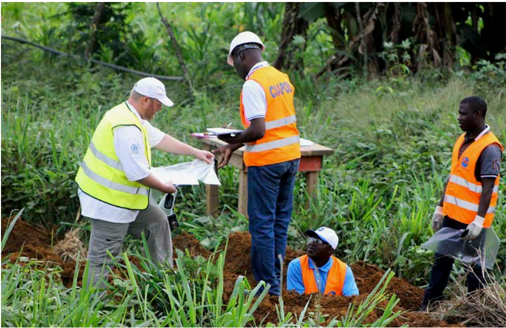
Bodenprobenahme in verschiedenen Tiefen an einem der sanierten Standorte
