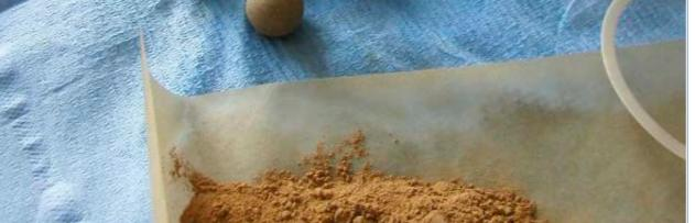
Eine getrocknete Bodenprobe wird zu feinem Pulver gemahlen.
