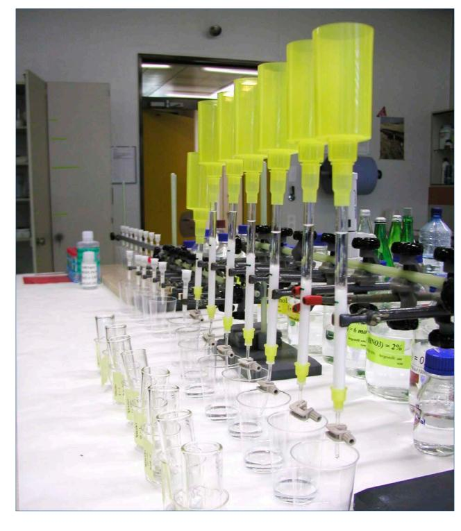
Nach Extraktion und diversen Fällungen werden die Sr-Isotope auf speziellem Säulenmaterial herausgetrennt und als Fällung durch einen Quarzfilter filtriert.
